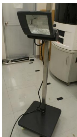
図 11 人工太陽灯プロブライツ V Fig. 11 Artificial sunlight Probright V manufactured by Nippon Paint Co., Ltd.
