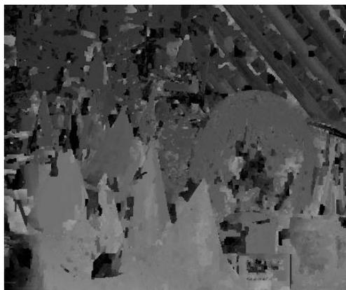
図 3. 階層グラフカットでステレオマッチングの視差画像
